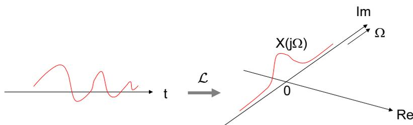
ただし，ラプラス変換は積分範囲を 0 から  $\infty$  に取っているので，変換される時間信号が  $t < 0$  で 0 であるようなものでないと一致しないけどな．
