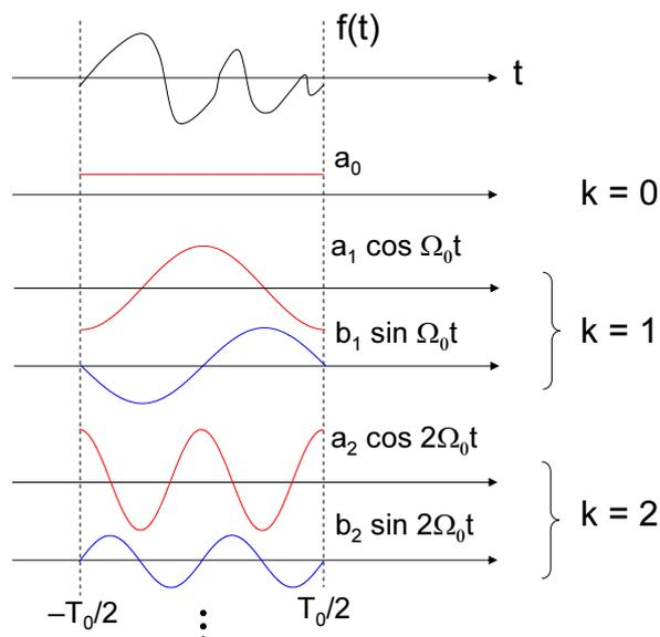
基本周期が 0.01 s なら，基本周波数は 100 Hz (基本角周波数 =  $2\pi \times 100$  [rad/s]) なので， $f(t)$  は直流成分と，100 Hz の成分，200 Hz の成分，300 Hz の成分... に分解されることになる．
