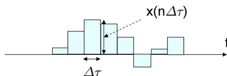
$n$  を整数として,  $t = n\Delta\tau$  の瞬間に高さ  $x(n\Delta\tau)$  の短冊が入力されることになるわけだが, その面積は  $x(n\Delta\tau)\Delta\tau$  なので, インパルス  $\delta(t - n\Delta\tau)x(n\Delta\tau)\Delta\tau$  が入力されたのと同じ効果だと考える. 高さを  $x(n\Delta\tau)\Delta\tau$  倍して時刻  $n\Delta\tau$  だけシフトしたインパルス関数と, この短冊 1 枚を同一視したってことだ.
