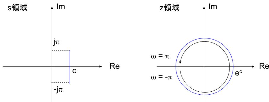
やらない夫 ちょっとした相違点として、ラプラス変換のときの積分経路は  $\Omega$  を  $-\infty$  から  $\infty$  まで動かしたが、z 変換の場合の  $\omega$  は  $-\pi \sim \pi$  でいいことに注意しておこう。離散時間フーリエ逆変換を導入したときに、積分範囲を  $-\pi \sim \pi$  に限定したのと同じ理屈だ。
