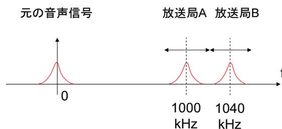
やる夫 放送局 B は  $\Omega_A = 1040 \times 2\pi \times 10^3$  の  $e^{j\Omega_B t}$  を振幅変調すれば、送信される電磁波は 1020 ~ 1060 kHz の範囲になるわけだお。周波数がかぶらないで済むお。
