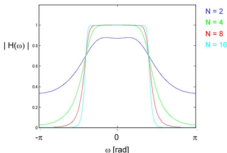
$N = 2$  のときがわかりやすいかな。  $\omega = \pi$  で折り返された結果、遮断域で振幅が下がりにくくなっている。
