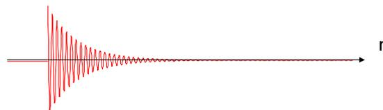
やる夫 あー，そうか，音叉の音量変化の波形が  $x[n]$  で，440 Hz のサイン波が搬送波だとすれば同じ話になるお．この場合も，フィルタを通したときに重要なのは包絡線の遅れの方で，440 Hz の振動の位相のずれの方じゃないお．
