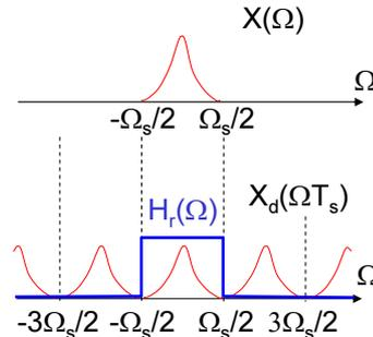
やる夫 つまり, サンプリング後の信号  $x_d[n]$  を, 離散時間フーリエ変換して, 角周波数  $-\Omega_s/2 \sim \Omega_s/2$  の範囲以外の成分をカットして, 残った成分を  $T_s$  倍して, それを逆フーリエ変換すれば元の信号  $x(t)$  になるってことかお.
