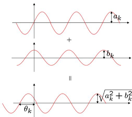
やらない夫  $\cos$  の方の音叉は  $a_k$  の強さで、 $\sin$  の方は  $b_k$  の強さで叩く必要があったわけだが、それを 1 個の音叉で代替できる。ただし、強さは  $\sqrt{a_k^2 + b_k^2}$  で、かつタイミングは位相が  $\theta_k = \tan^{-1} \frac{a_k}{b_k}$  だけずれるように叩く必要があるわけだ。
