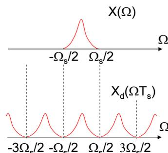
やらない夫 そうだ．だから， $-\Omega_s/2 \sim \Omega_s/2$  の部分だけ抜き出してくるような処理をしてやれば，元のスペクトル  $X(\Omega)$  が完全に取り出せることになる．数式で書いたらこうだな．
