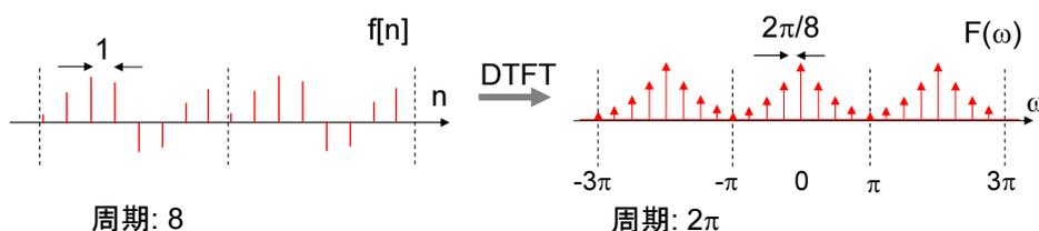
やらない夫 そうだな。前回で、周期的スペクトルのフーリエ逆変換を考えたとき (p. 64) と同じことが起きているわけだ。時間と周波数が逆だけだ。周期的でない時間信号の場合に連続的に広がっていたスペクトルが、一定間隔の飛び飛びの線の並びにギュッと圧縮されるイメージだ。
