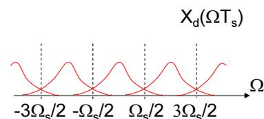
やらない夫 その図だとすそ同士をかさねて描いてあるが，実際には重なったところは足し算になるという点に注意して欲しい．その結果，元の信号の異なる周波数が混ざってしまって区別できなくなるわけだ．例えば元の信号の帯域が 100 Hz だったとしよう．この信号を 150 Hz でサンプリングしたとする．
