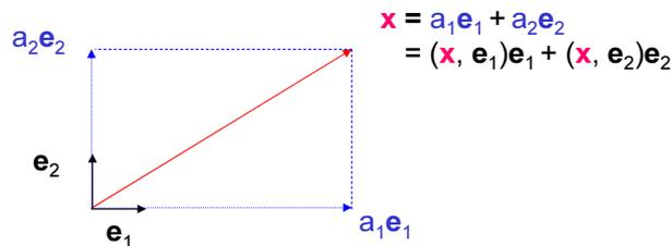
$x$  から  $e_i$  の延長線上に垂線を下ろして、分解された成分の長さを決めるんだお。その成分の長さは、 $x$  と  $e_i$  の間の角度を  $\theta$  として  $\|x\| \cos \theta$  になるわけだけど、 $\|e_i\| = 1$  だから、 $\|x\| \cos \theta = \|x\| \|e_i\| \cos \theta = (x, e_i)$  になるんだお。
