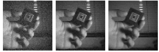
(a) 1 ms (b) 2 ms (c) 4 ms 図 12 変換スケール固定・異なる撮像時間での撮像結果 Fig. 12 Experimental results of fixed-scale, different-frame-rate imaging.
